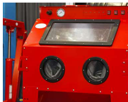
Imagen de un cerramiento para chorreado con arena.
