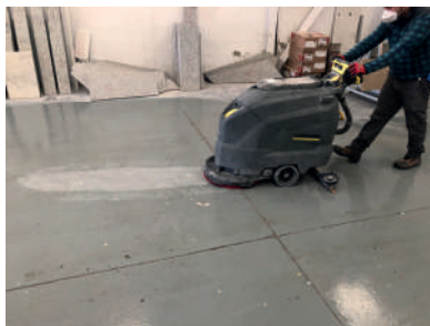
Fig. 6.3. Fregadora de suelos en marmolería (Fuente: INS)
