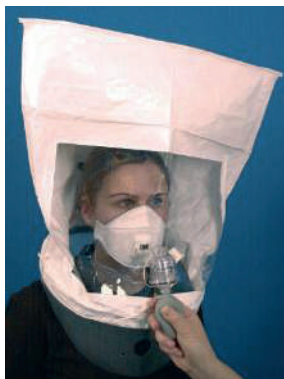
Fig. I.4. Test de ajuste cualitativo (Fuente: 3M)
